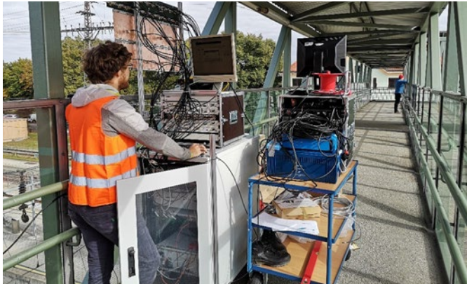
2: Massive MIMO Messaufbau zur Messung der Funkkanaleigenschaften Quelle: AIT
