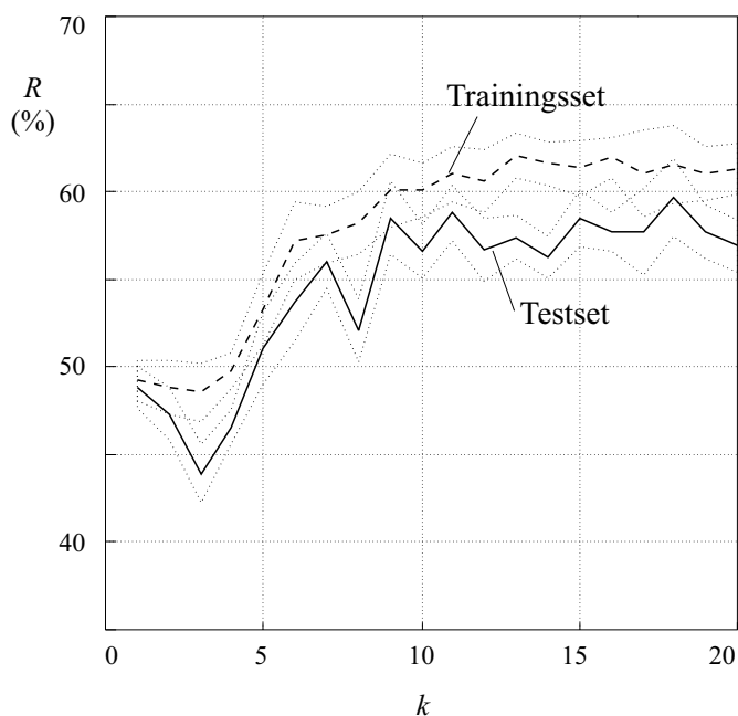
Abb. 4.8: Erkennungsrate R des Test- und Trainingssets bei variiertem Anzahl k der LPCC-Koeffizienten. Die dicken Linien stellen den Mittelwert, die dünnen Linien die Standardabweichung dar.
